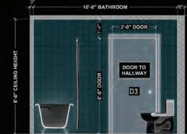
E-1 SECTION - BATHROOM 2.02 SCALE: 1/2" = 1'-0"
