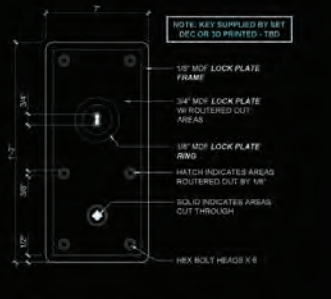
6 DETAIL - LOCK PANEL 4.03 SCALE: 3"=1'-0"
